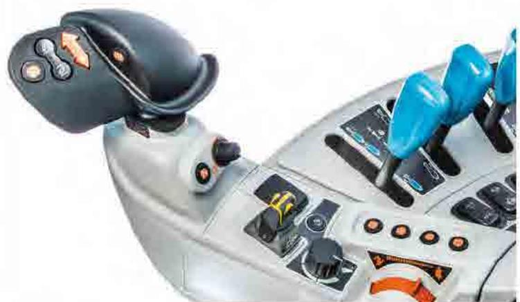
Algunos mandos adicionales están centrados en el lado derecho en todos los modelos de la M7001. El modelo de serie tiene un reposabrazos rígido que termina con la palanca multifunción, mientras que los modelos avanzados están equipados con un reposabrazos más avanzado de tipo flotante.
