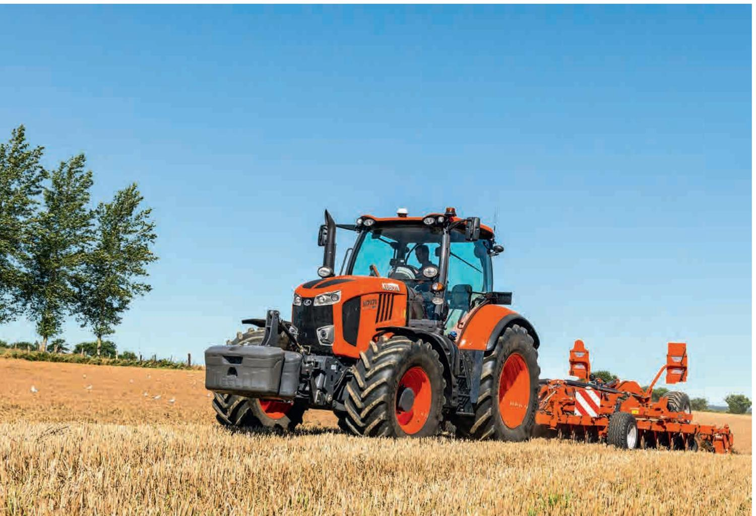
La enorme capacidad de elevación del M7001, de 9.400 kg le permite trabajar sin mayor problema con sembradoras combinadas y otros aperos pesados tales como arados, cultivadores, etc. El enganche delantero con una capacidad de 3.500 kg ofrece una capacidad de
