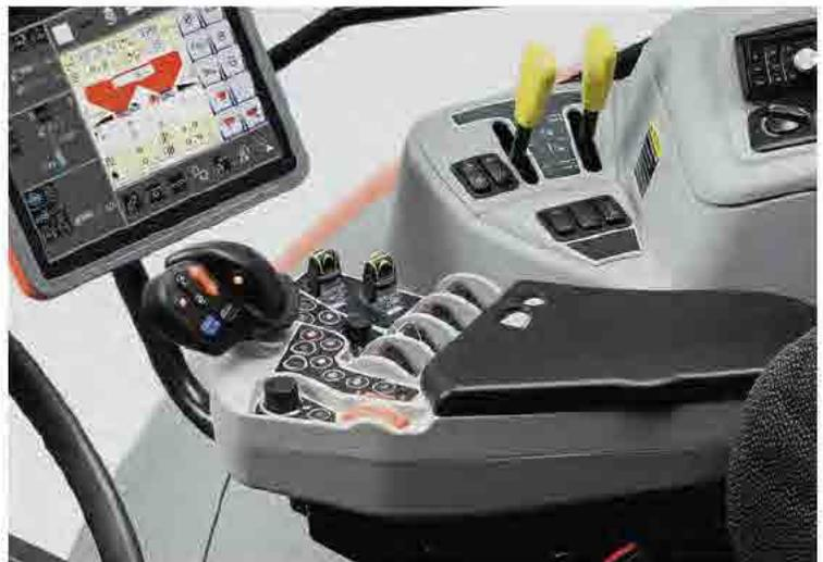
Para el modelo avanzado de la serie M7001, Kubota ha integrado todos los elementos de control en el reposabrazos flotante. Todos los elementos de control usados frecuentemente están al alcance sin tener que levantar el brazo. Esto se traduce en un mayor confort y una mayor productividad que incluye un manejo intuitivo.
