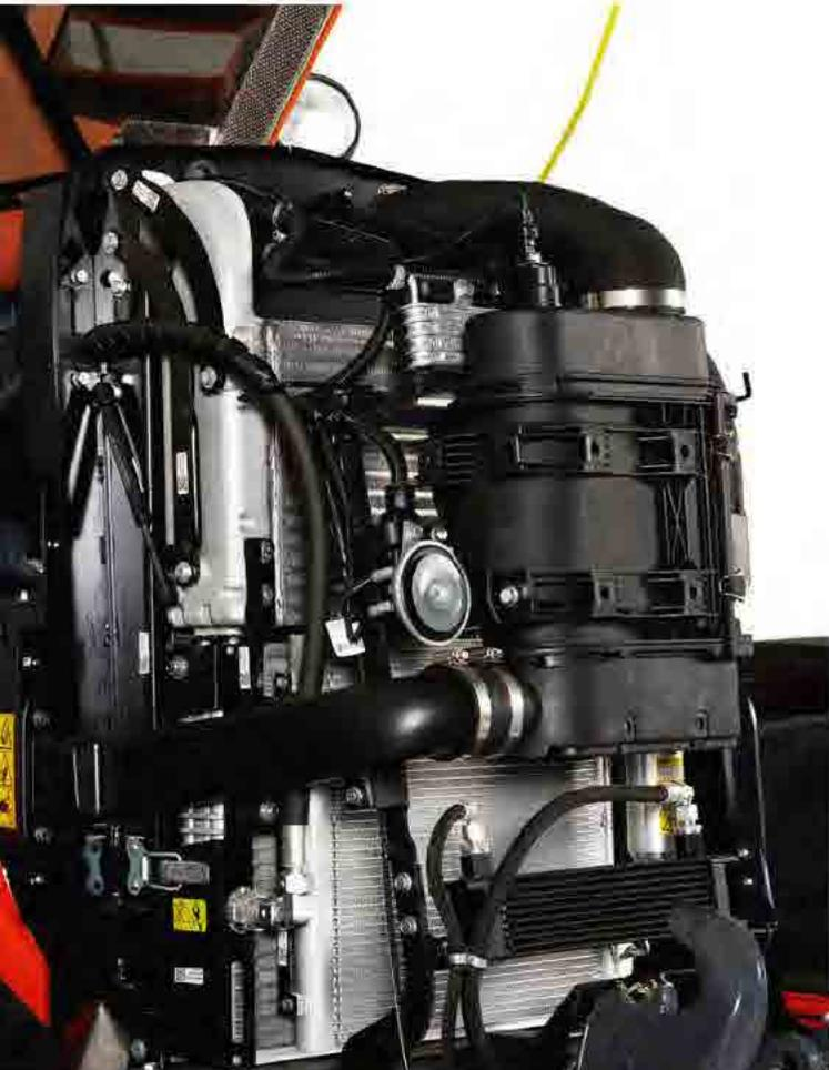
Bajo el capó del M7001 se esconde la última tecnología en motores de alta eficiencia del Grupo Kubota, uno de los principales fabricantes mundiales de motores diésel industriales. Los tres modelos alcanzan un máximo de 130, 150 y 170 CV (más otros 20/20/5 CV con sistema Power Boost) y están equipados con un sistema de filtrado de aire de alta eficiencia.
