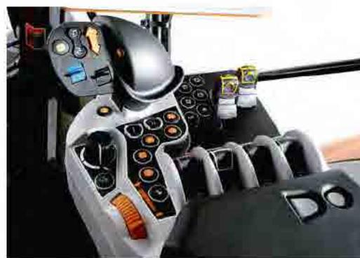
Los modelos Premium de la serie M7001 ofrecen un sistema hidráulico de centro cerrado y caudal variable con sensor de carga que puede realizar múltiples acciones simultáneamente. El sistema está impulsado por una bomba de 110 litros independiente con cuatro distribuidores hidráulicos accionados electrónicamente. Opcionalmente puede disponer de hasta dos válvulas adicionales. Los clientes que requieran el máximo caudal y control para sus aperos disponen de la tecnología Power-Beyond.
