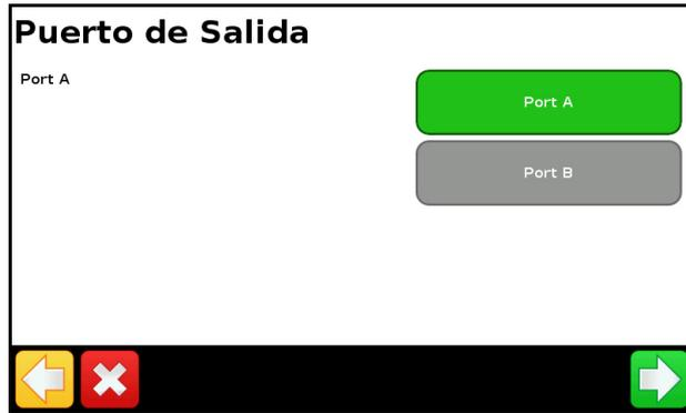
2. En la pantalla CFX-750, asegúrese de que el puerto de salida coincida con el puerto de la pantalla al que se ha conectado el controlador (COM o AUX).
