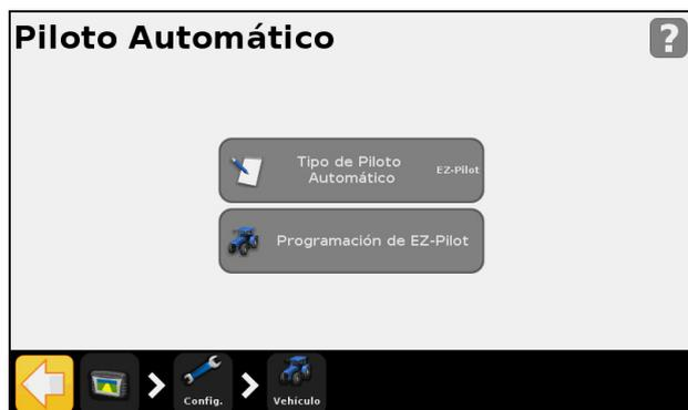
**Nota** – Si no se muestra el botón de Programación de EZ-Pilot toque Sistema de Piloto Automático y seleccione EZ-Pilot para su controlador.
