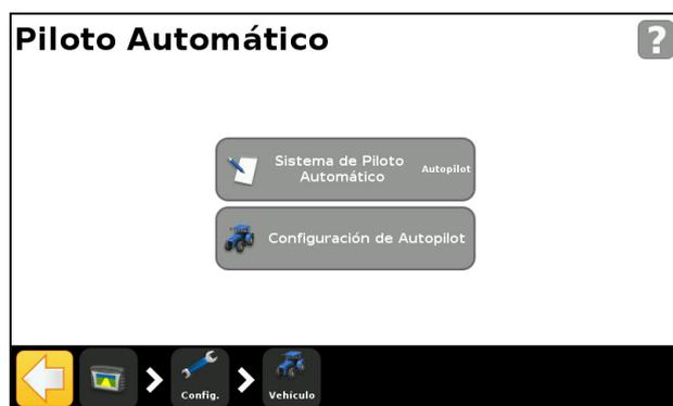
*Nota* – Si el botón de Configuración de Autopilot no aparece, toque Sistema de Piloto Automático y seleccione Autopilot para su controlador.
