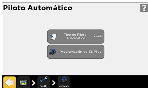
**Nota** – Si el botón de Programación de EZ-Pilot no aparece, toque Sistema de Piloto Automático y seleccione EZ-Pilot para su controlador.
