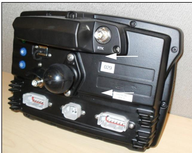
2. Acople el soporte RAM a la bola de la placa de montaje rómbica:
