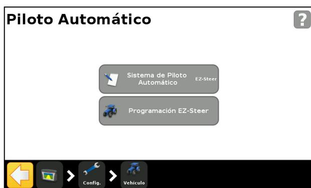
**Nota** – Si no se muestra el botón de Programación EZ-Steer, toque Sistema de Piloto Automático y seleccione EZ-Steer para su controlador.
